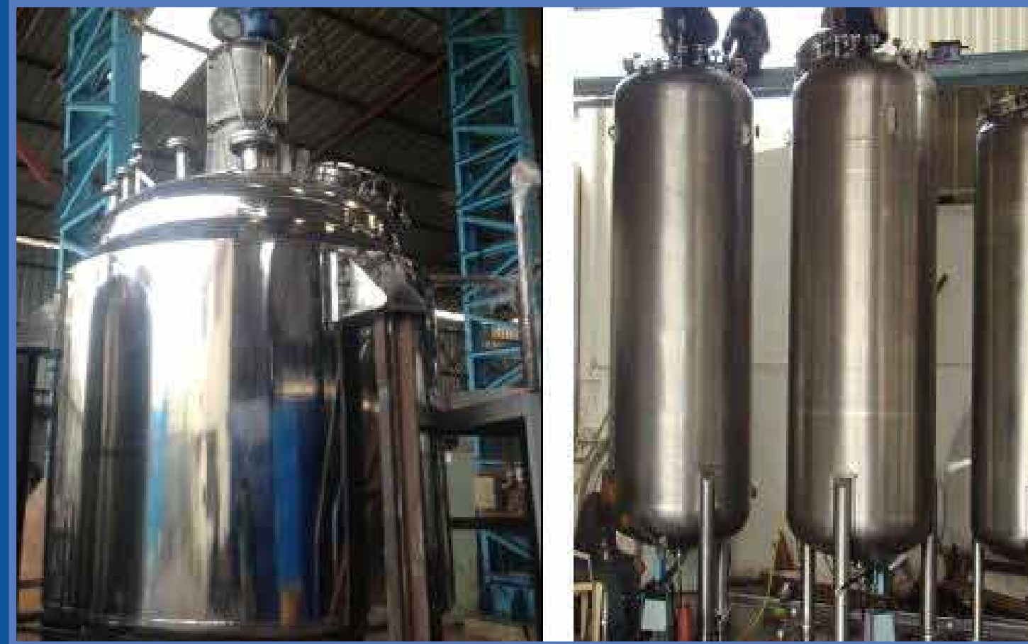
3 KL Reactor / 5 KL Day Tanks
